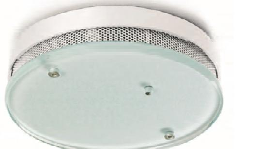
Rivelatore analogico indirizzato di tipo ottico per il sistema loop 3000 con isolatore di linea bidirezionale integrato. Doppio circuito di misurazione ottica. Sensibilità del sensore programmabile anche in funzione di fasce orarie.
